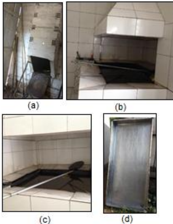
FIGURA 6 - APRESENTAÇÃO DOS EQUIPAMENTOS: ENTRADA FORNALHA (a), CHAMINÉ COM EXAUSTOR (b); TACHOS PARA CONCENTRAÇÃO (c) E TACHOS PARA CRISTALIZAÇÃO (d) DA AGROINDÚSTRIA B.
