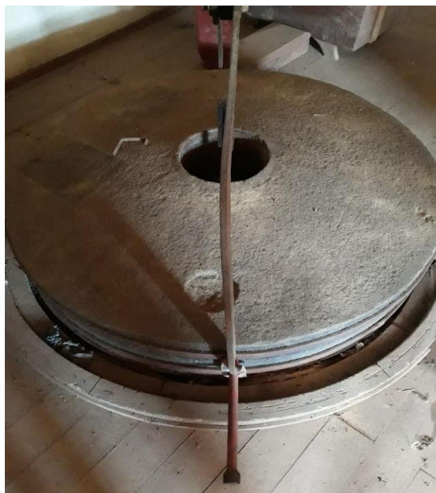
Figura 7 – Moinho de pedra utilizado na produção de farinha de milho.
