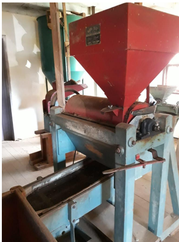
Figura 6 - Canjiqueira utilizada na produção de farinha de milho.
