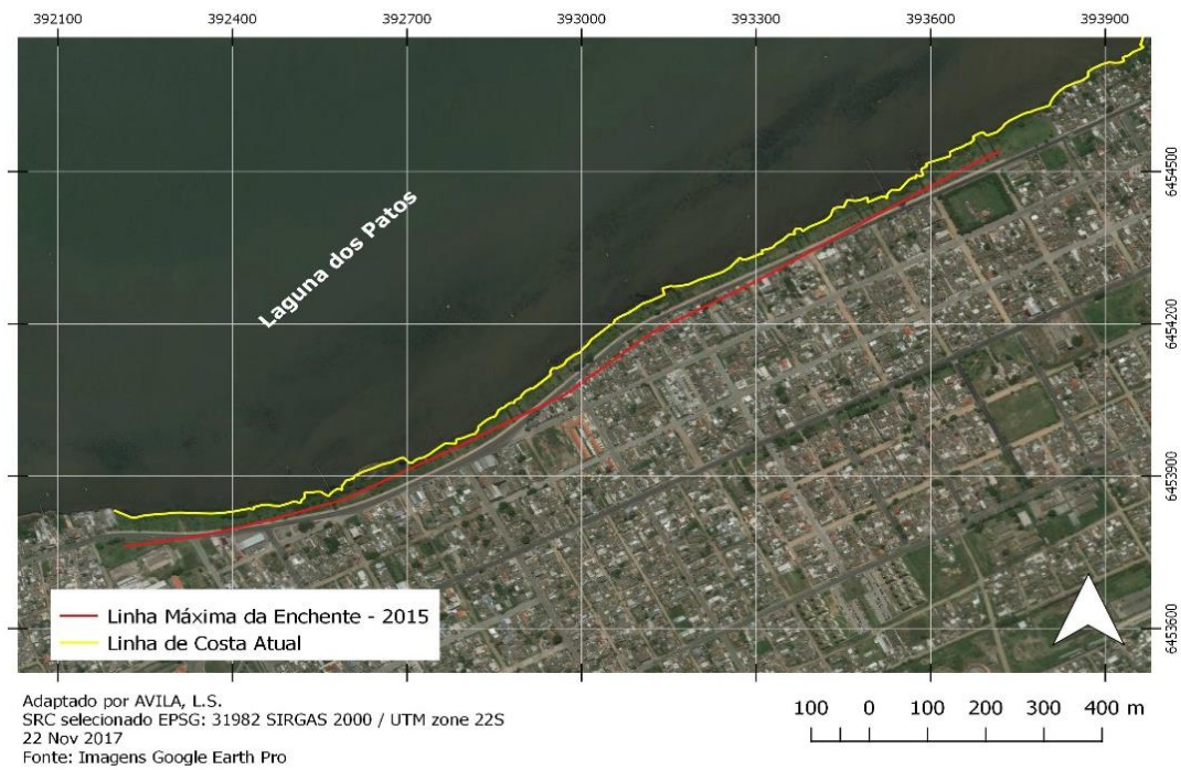
Figura 24. Localização da Linha de enchente do trecho da Rua Henrique Pancada
