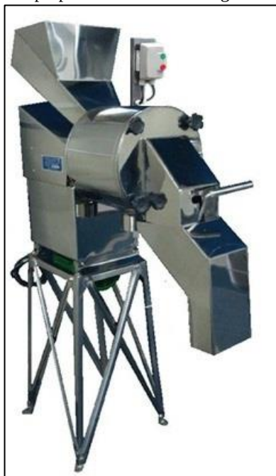
Figura 15 – Despolpador de frutas Tortugan modelo MS-450
