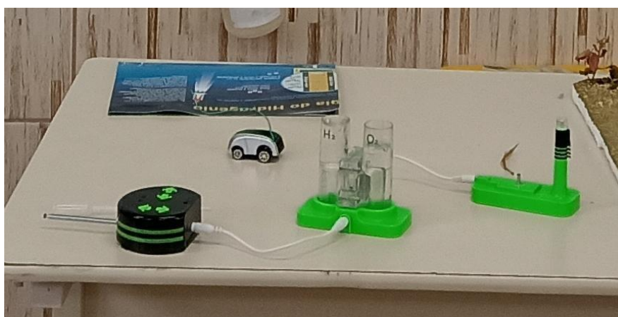
Figura 4 - Protótipo EcoRacer Water Power ® que produz hidrogênio
