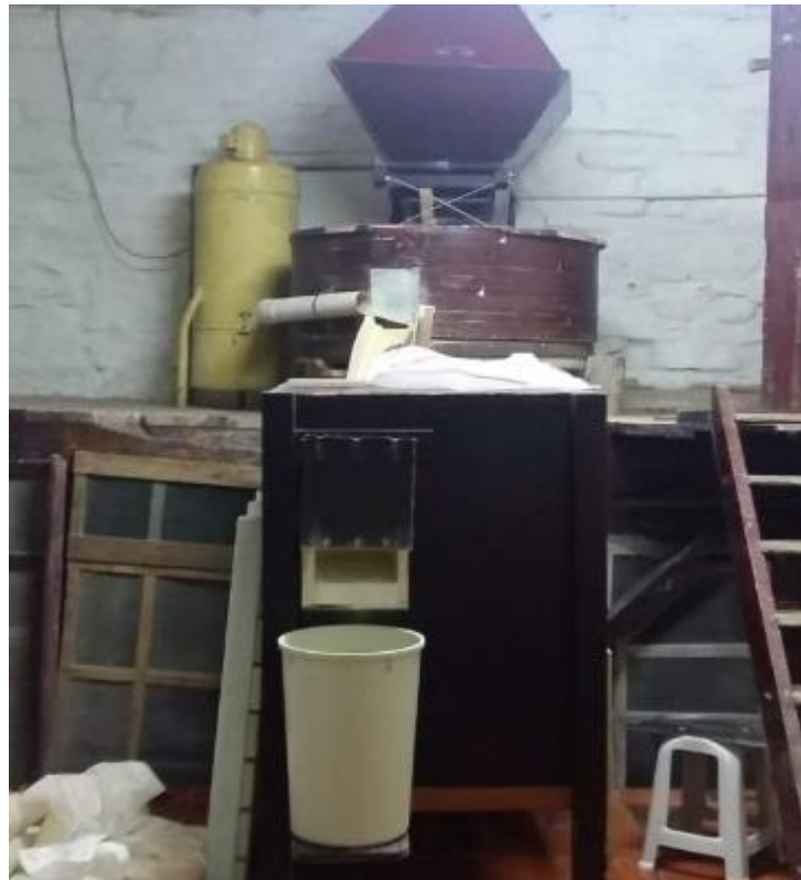
Figura 3. Moinho de pedra para produção de farinha de milho.
