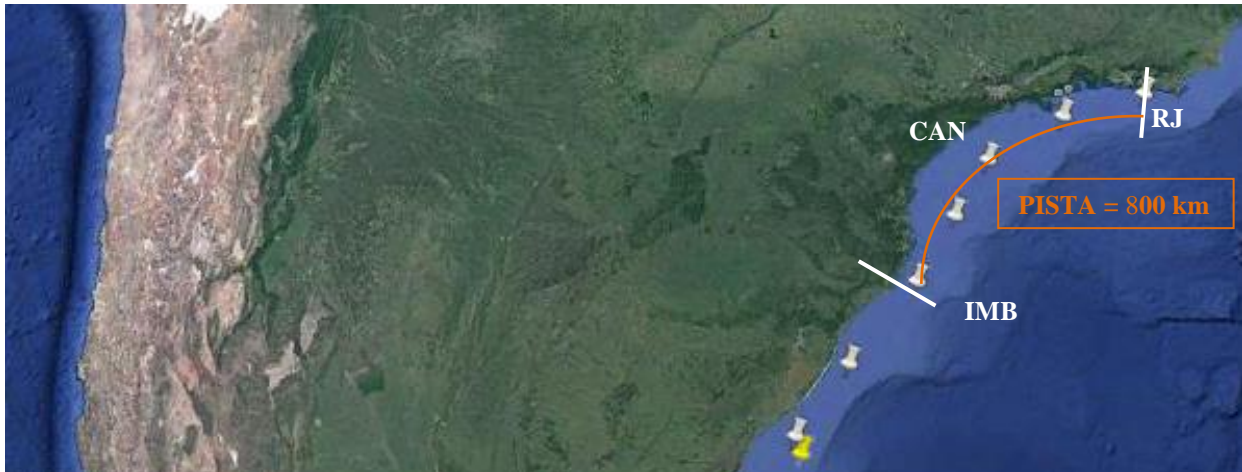
Figura IV.24 – Trecho de Plataforma Continental usado para aplicação do modelo. IMB = Imbituba, CAN = Cananeia, RJ = Rio de Janeiro. Características do trecho: comprimento 800\text{ km} , h_o = 90\text{ m} e L_{otim} = 155\text{ km} , com C_m = 9.2\text{ m/s}
