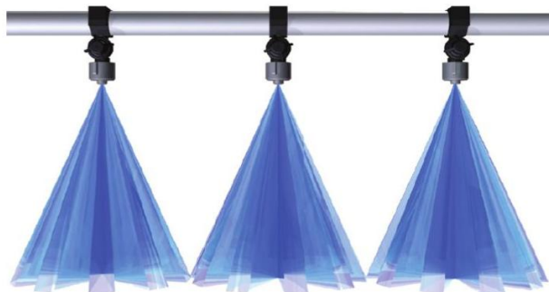
Figura 5 – Esquemática dos chuveirinhos para umedecimento das formas.
