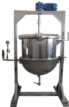
Figura 3 – Tacho aberto encamisado, com aquecimento à vapor e misturador.
