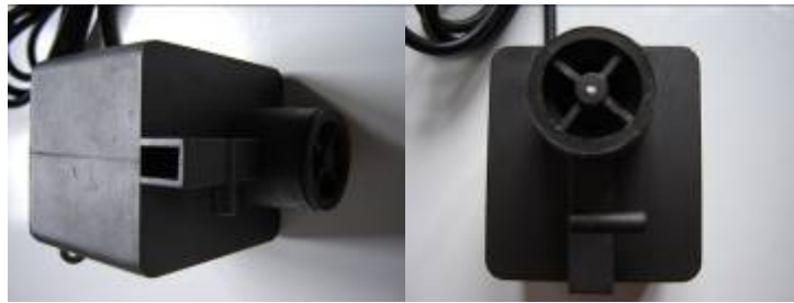
Figura 4.10 – Detalhe da bomba de circulação d'água
