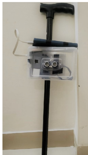
Figura 12: Protótipo de Bengala Inteligente com detecção de Objetos
