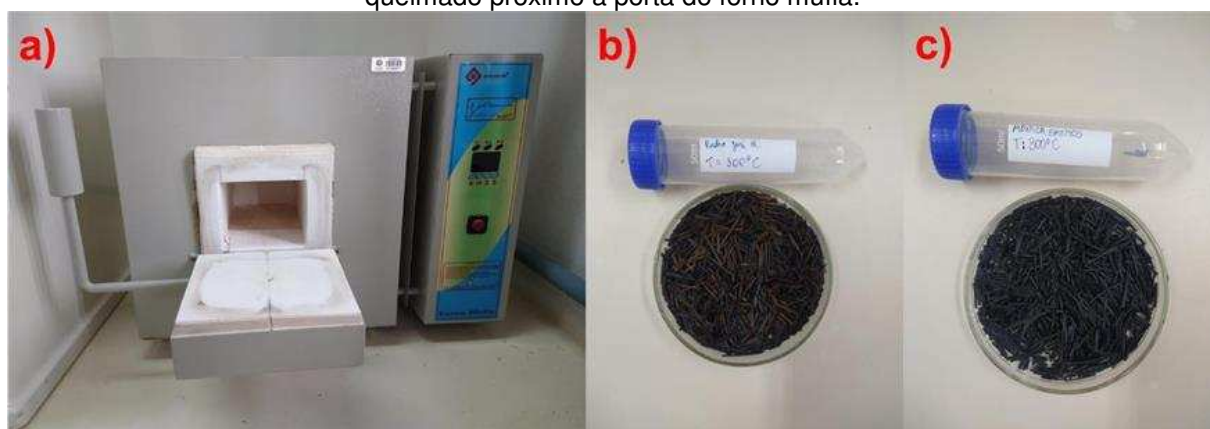
Figura 1 - a) Forno mufla utilizado. b) Carvão CP300 queimado no fundo da mufla c) CP300 queimado próximo a porta do forno mufla.
