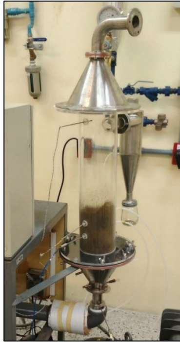
Figura 4.5: Equipamento de leito fluidizado
