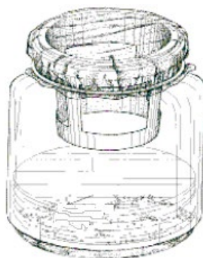
Figura 4.3: Aparato experimental para determinação da umidade de equilíbrio
