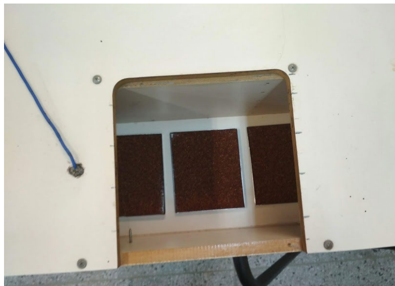
Figura 8: Disposição da amostra em bandeja para a secagem em camada delgada
