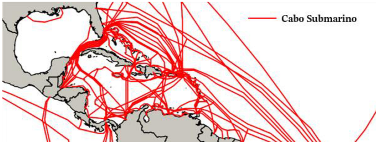
Figura 2.4. Esquema mostrando parte dos cabos submarinos de fibra óptica que ligam a América do Sul e a América do Norte. 4,5
