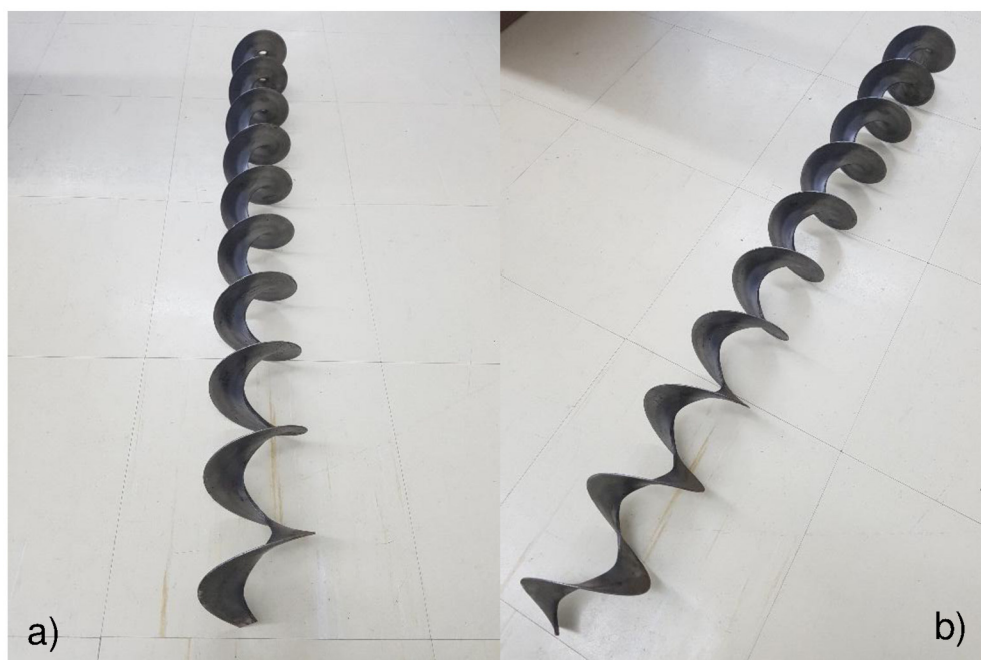
Figura 10 - Rosca sem fim de dosador de sólidos, próprio autor a) imagem longitudinal, b) imagem inclinada.
