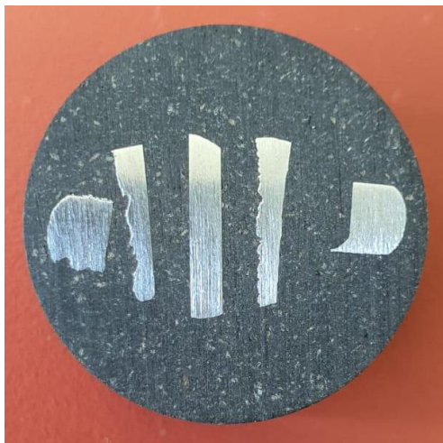
Figura 11 - Amostras embutidas, imagem durante preparação.
