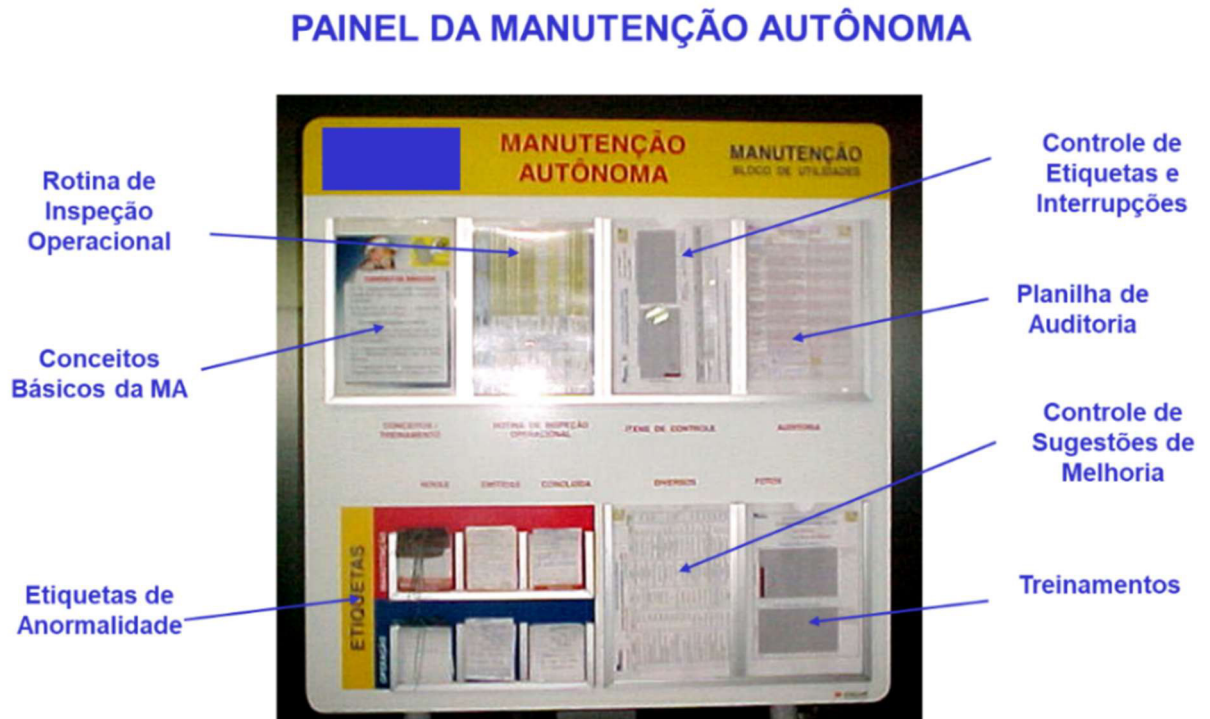
Figura 9 - Painel da Manutenção Autônoma
