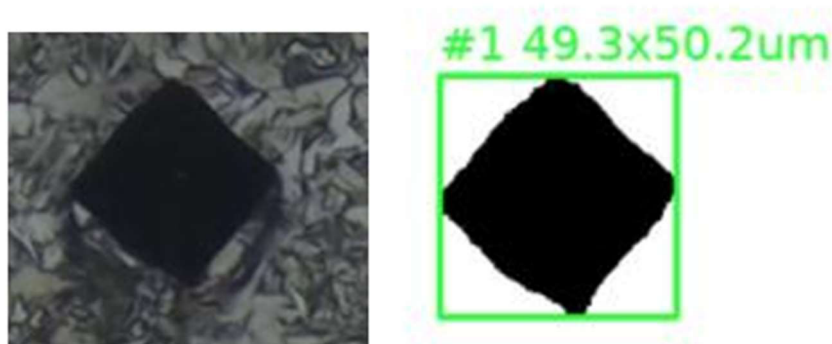
Figura 20 - Detalhe do Software - Conversão da imagem em pixel pretos e brancos para leitura e processamento dos dados.
