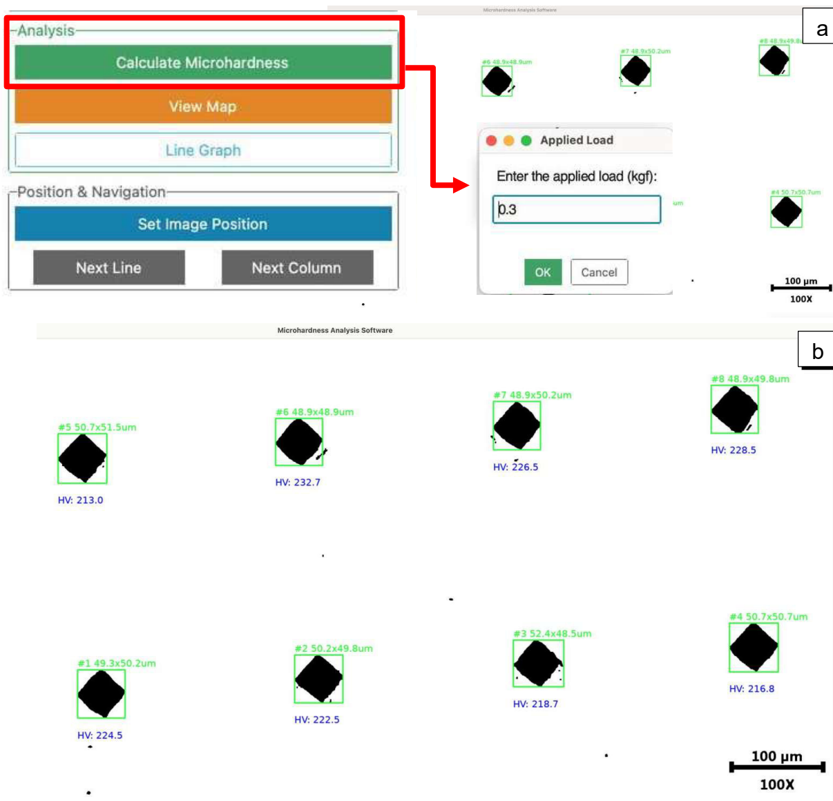
Figura 22 - Detalhe do Software - (a) Aplicação da carga e resultados de microdureza; (b) Representação dos resultados das impressões Vickers conforme carga aplicada.
