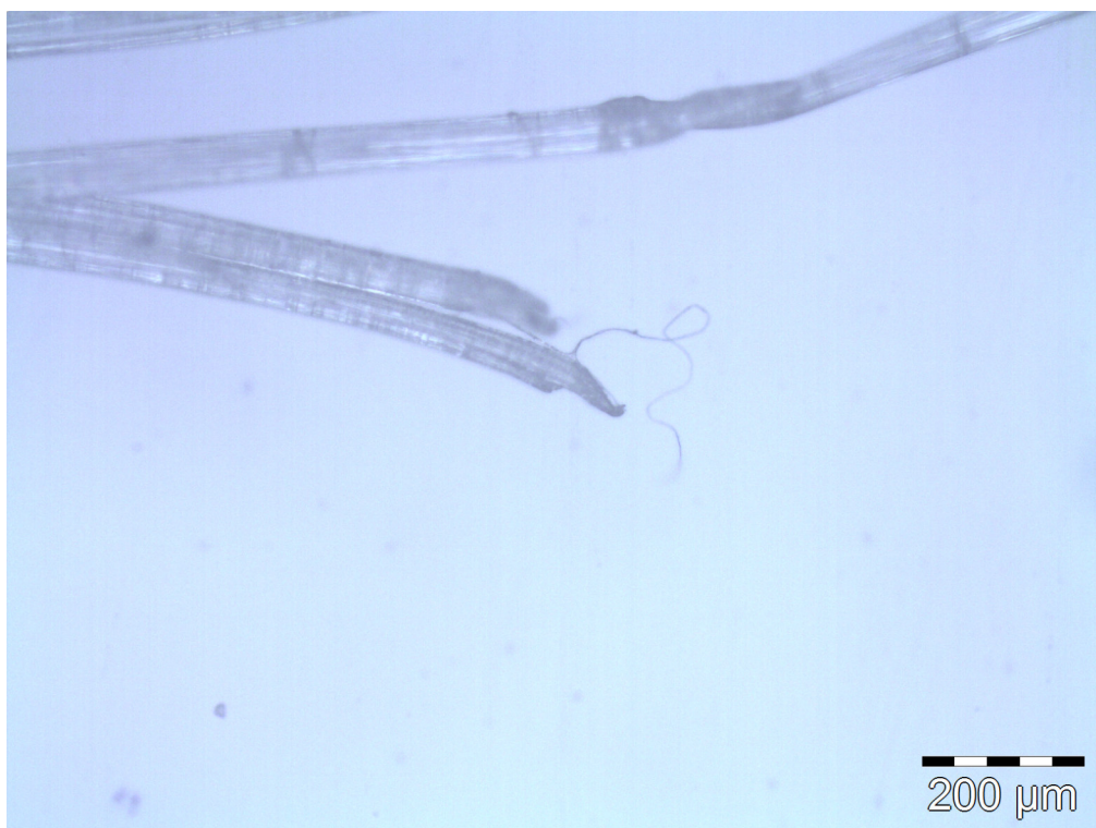
Figura 55: Amostra de ruptura por fadiga com carga de 50 a 10% da carga de ruptura na frequência de 1,0 Hz (2).
