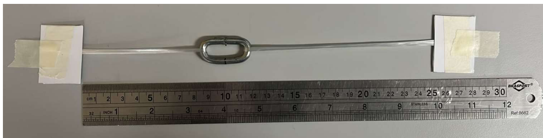
Figura 3.2 – Corpo de prova híbrido com dois materiais associados em série.
