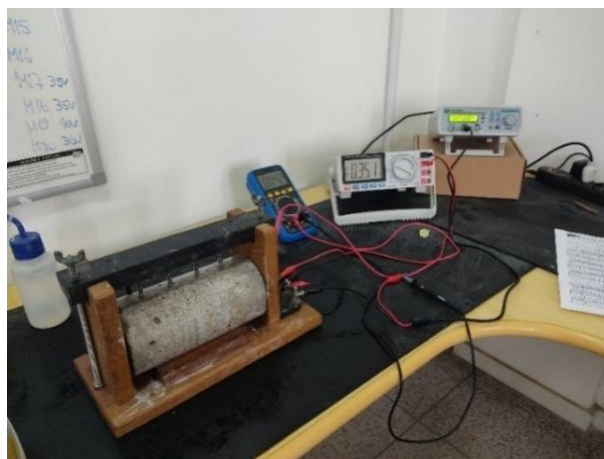
Figura 3.18: Determinação da resistividade elétrica superficial.
