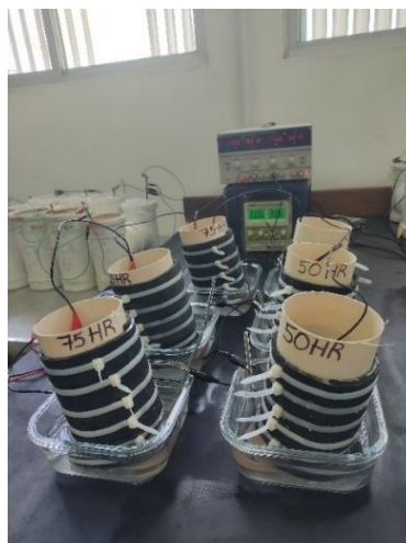
Figura 3.9: Determinação do coeficiente de migração de cloretos no estado não estacionário.
