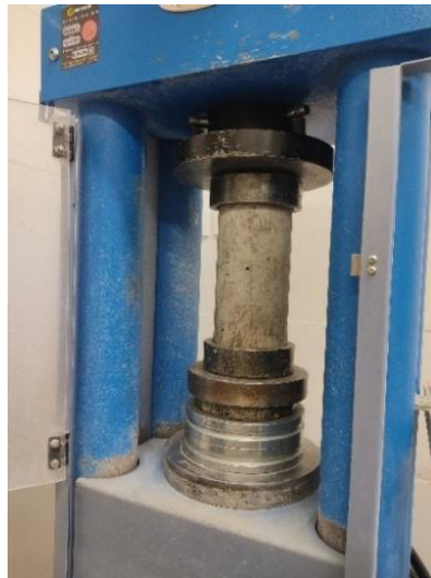
Figura 3.5: Determinação da resistência à compressão axial.
