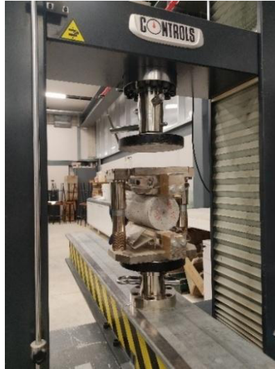
Figura 3.6: Determinação da resistência à tração por compressão diametral.
