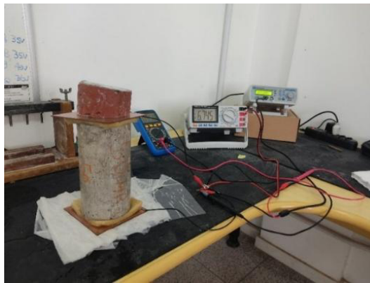
Figura 3.14: Determinação da resistividade elétrica volumétrica.
