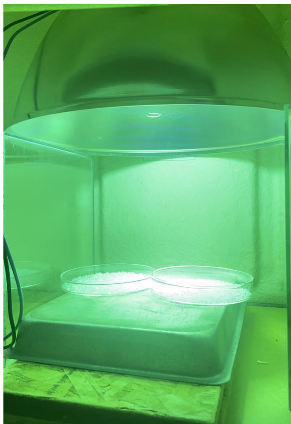
Figura 7. Montagem experimental para a exposição de microplásticos a radiação ultravioleta, utilizando lâmpada de vapor de mercúrio de 400 W sem invólucro externo.
