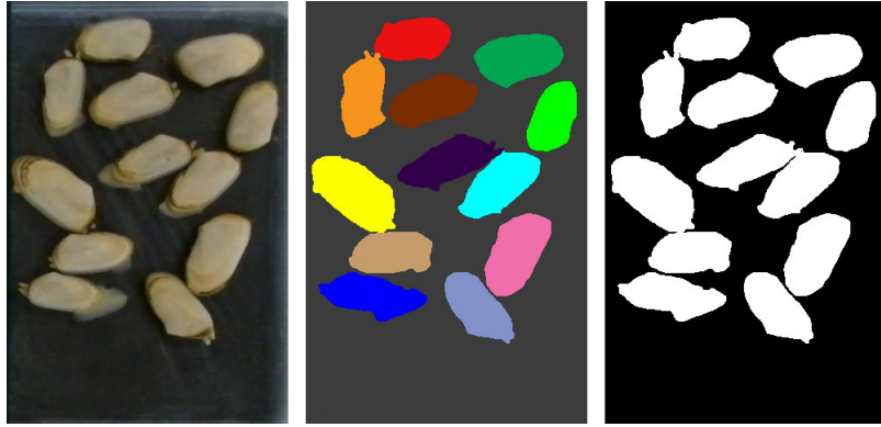
Figura 4.2: Comparação entre ROI extraída, imagem anotada e ground truth binarizado, respectivamente
