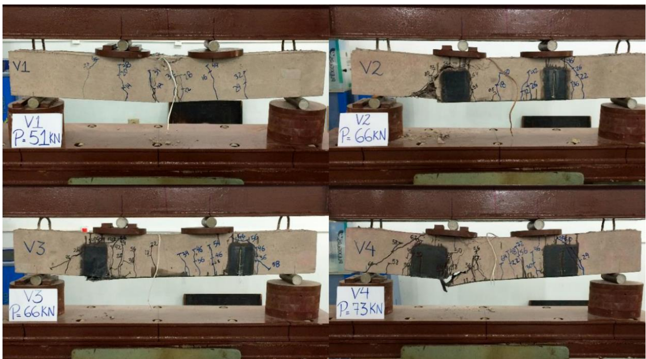
Figura 4.9 - Vigas de Ferreira et al. (2018) após ruptura Fonte: Ferreira et al. (2018)
