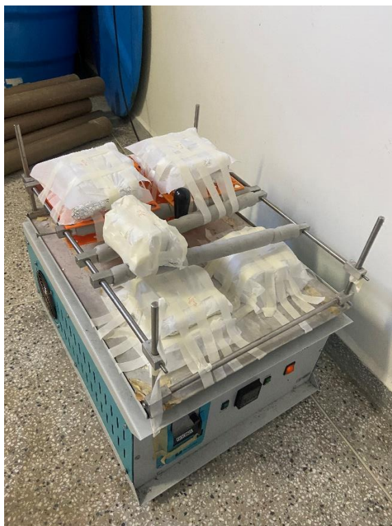
Figura I- 5: Agitação dos lixiviados em mesa agitadora orbital.
