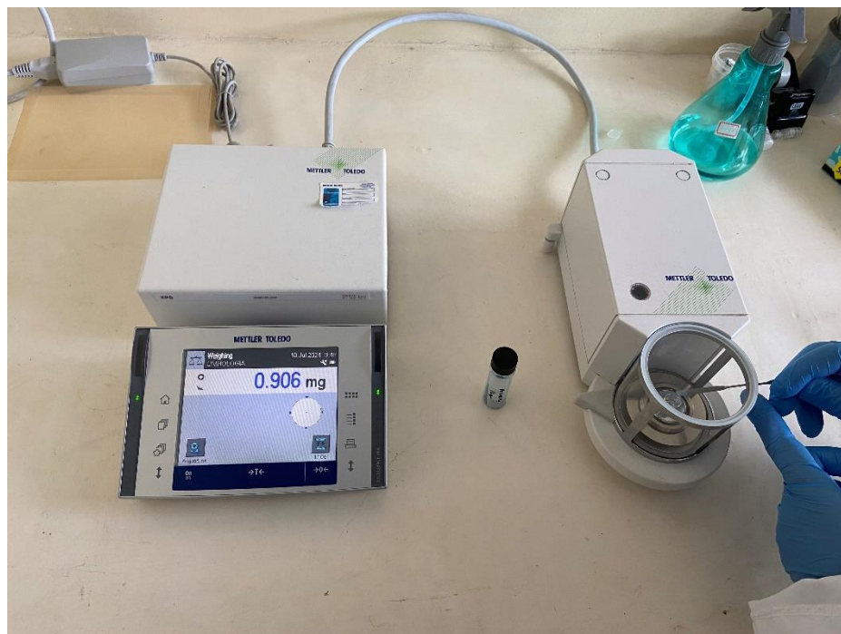
Figura I- 4: Pesagem das partículas de tintas anti-incrustantes na balança de alta precisão.
