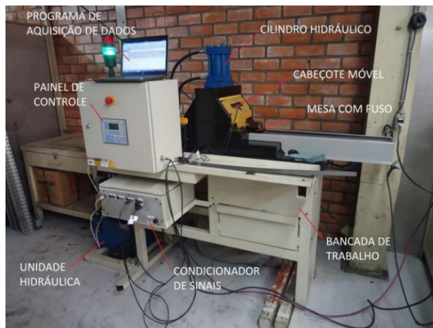
Figura 19 - Máquina para ensaios de estiramento à esquerda. À direita um esquema representativo do movimento relativo da amostra e a chapa durante ensaio (De Souza e Liewald (2010)).
