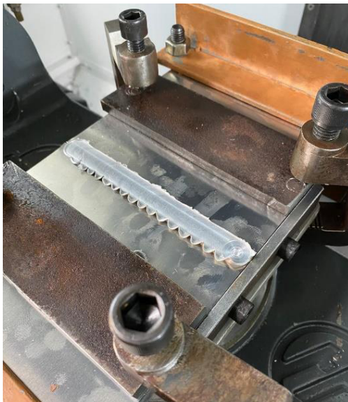
Figura 12 - Junta soldada por FSW aprovada qualitativamente
