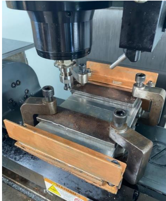
Figura 9 - Sistema de fixação e chapas fixadas na máquina CNC
