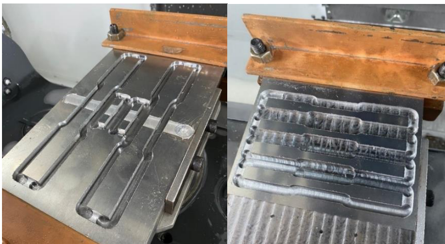
Figura 14 - Usinagem de corpos de prova de tração e amostras
