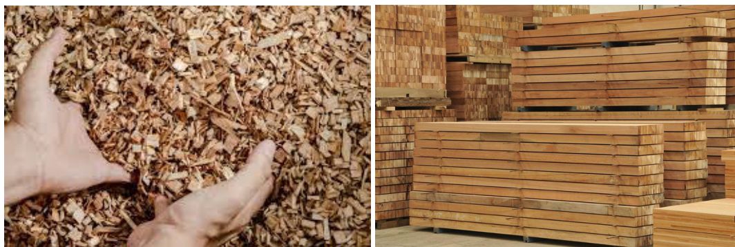
Figura 2: Alguns subprodutos das toras de madeira: cavacos (à esquerda) e laminados (à direita). Fonte: [61]
