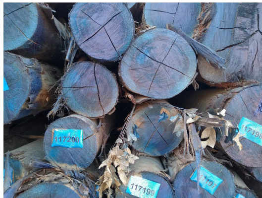
Figura 3: Pilha de toras de eucalipto, com destaque para as rachaduras das seções transversais. Fonte: o autor.
