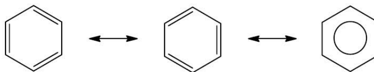
Figura 1.12: Estrutura trigonal plana da molécula de Benzeno com ligações duplas e simples distribuídas alternadamente.
