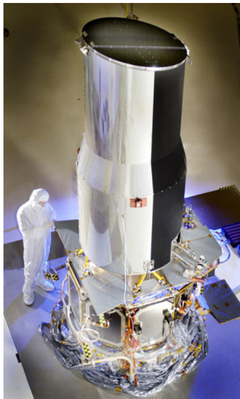
Figura 2.1: Telescópio Espacial Spitzer, lançado no ano de 2003, especificamente desenvolvido para realizar observações no comprimento de onda do Infravermelho. Fonte: http://www.spitzer.caltech.edu/
