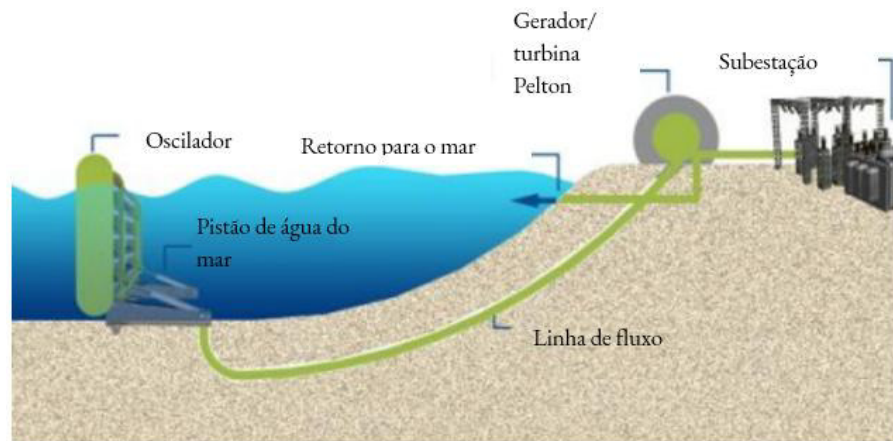
Figura 2.3: Funcionamento do dispositivo Oyster (Adaptado de: Whittaker et al. , 2007).
