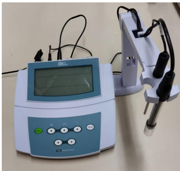
Figura 13 - Condutivímetro de bancada W12D da marca Bel
