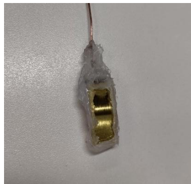
Figura 27 - Corpo de prova imerso em solução de ácido cítrico (pH 4,5) com deformação de 30°, após 30 minutos
