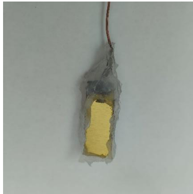
Figura 29 - Corpo de prova imerso em solução de ácido cítrico (pH 4,5) com deformação de 0°, após 15 dias.
