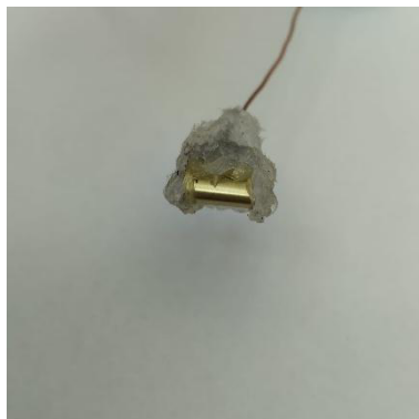
Figura 31 - Corpo de prova imerso em solução de ácido cítrico (pH 4,5) com deformação de 180°, após 15 dias.
