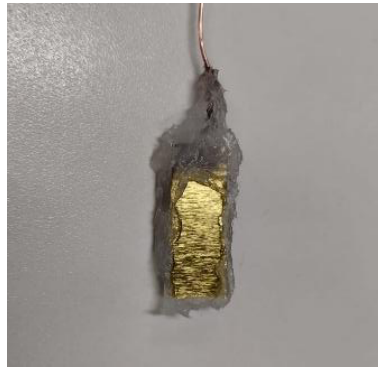
Figura 26- Corpo de prova imerso em solução de ácido cítrico (pH 4,5) com deformação de 0°, após 30 minutos
