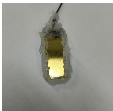
Figura 21- Corpo de prova imerso em solução de ácido cítrico (pH 3,0) com deformação de 30°, após 15 dias
