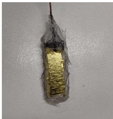
Figura 20- Corpo de prova imerso em solução de ácido cítrico (pH 3,0) com deformação de 0°, após 15 dias
