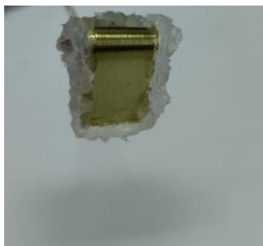
Figura 19 - Corpo de prova imerso em solução de ácido cítrico (pH 3,0) com deformação de 180°, após 30 minutos
