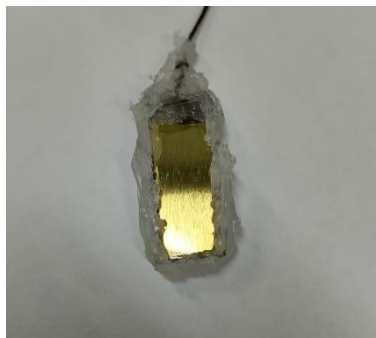
Figura 33 - Corpo de prova imerso em solução de ácido cítrico (pH 4,5) com deformação de 30°, após 35 dias.
