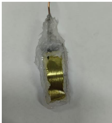
Figura 30 - Corpo de prova imerso em solução de ácido cítrico (pH 4,5) com deformação de 30°, após 15 dias.
