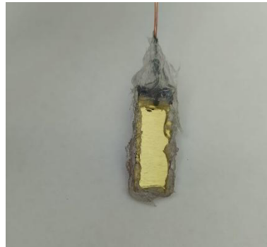
Figura 23- Corpo de prova imerso em solução de ácido cítrico (pH 3,0) com deformação de 0°, após 35 dias
