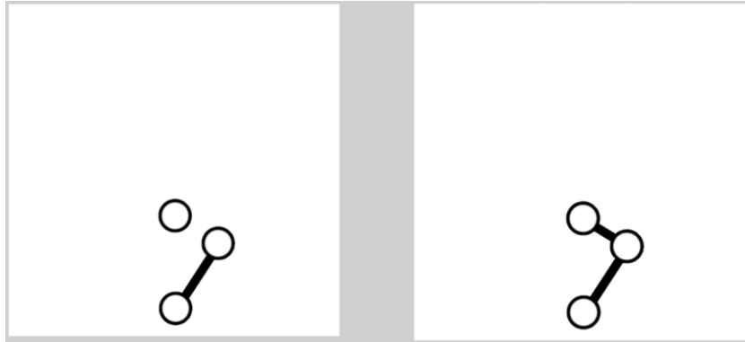
Figura 2.9. – Exemplo de passo de crescimento do RRT para o caso da Figura 2.8.
