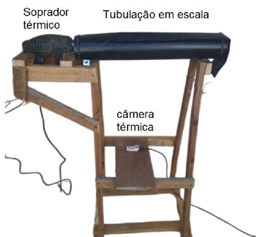
Figura 10: Visão da configuração real para obtenção da imagem térmica. Fonte: Elaborado pela autora
