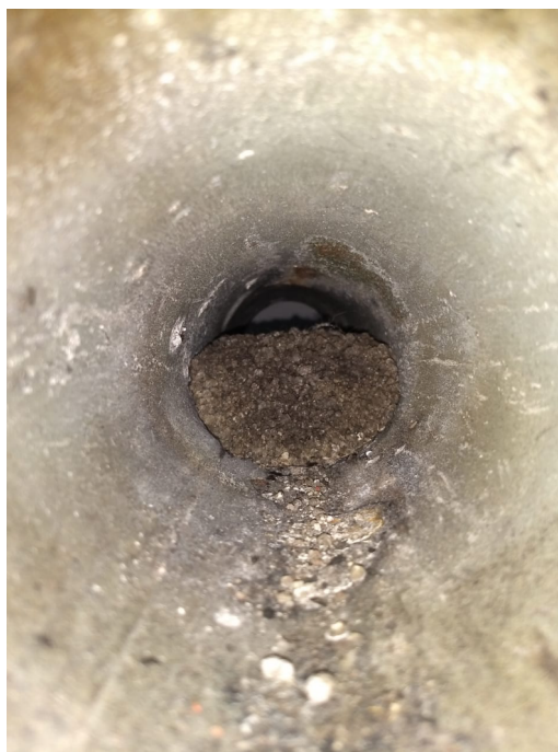
Figura 12: Fertilizante úmido no interior do tubo.
