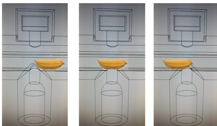
Figura 28: Ilustração das posições da semente durante o ensaio dinâmico
