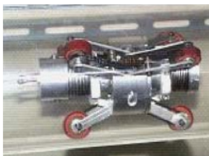
Figura 2.16: Mini robô proposto para realizar tarefas de inspeção nas tubulações.
