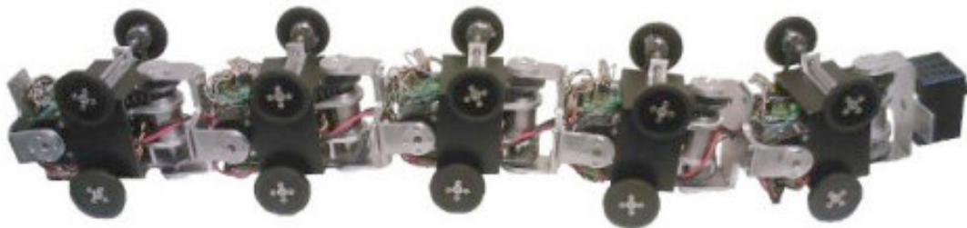
Figura 2.27: Robô de inspeção de tubos (PIKo).
