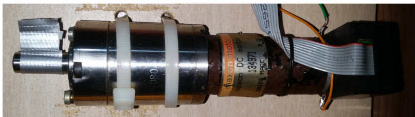
Figura 9: Atuador do tipo moto-redutor Harmonic-Drive Fonte: Próprio Autor
