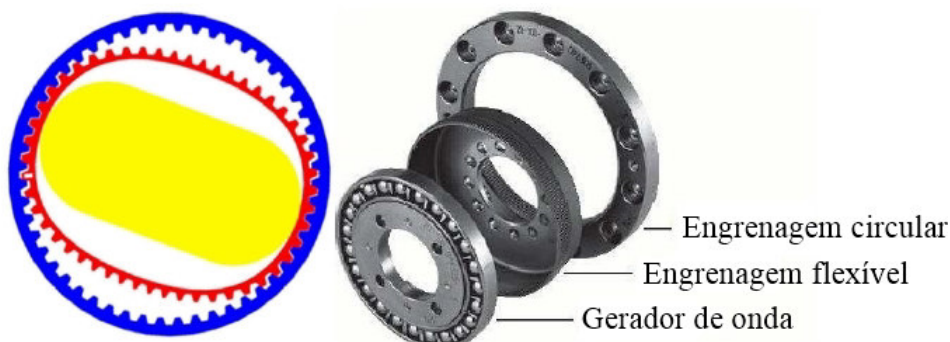
Figura 10: Estrutura interna do Harmonic-Drive Fonte: Adaptado de (ZEILMANN et al., 2010)
