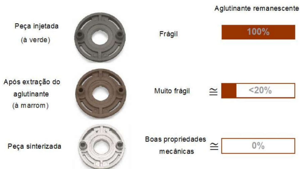
Figura 4 – Propriedades mecânicas das peças entre as etapas do processo MIM.
