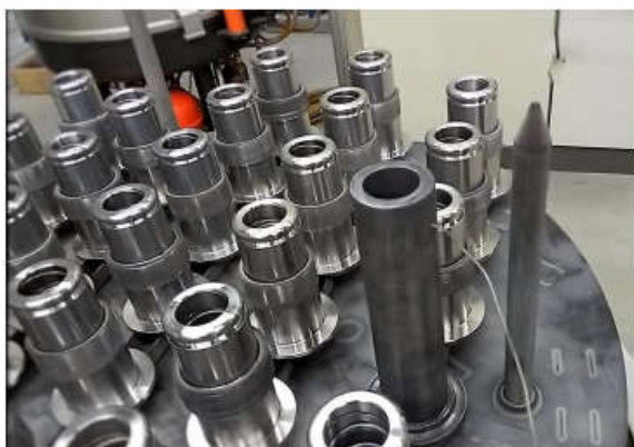
a) Início com as peças preparadas catodicamente.
