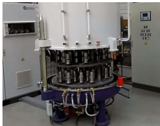
b) Fechamento da câmara do reator.
