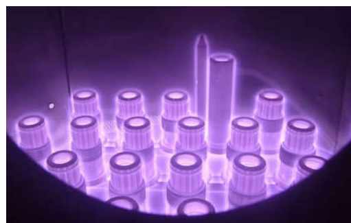
d) Íons bombardeando a superfície das peças criando uma região brilhante.
