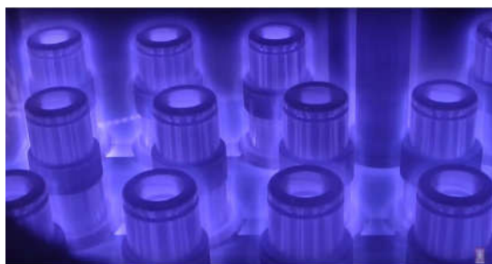
c) Início da ionização e limpeza das peças gerando o efeito luminoso.
