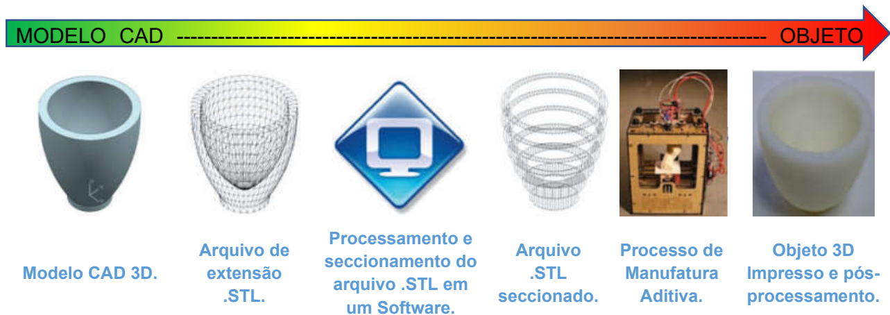
Figura 7 - Processo generalizado da Manufatura Aditiva.
