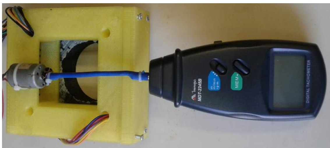
Figura 31 – Simulador do batimento das asas de moscas-das-frutas com tacômetro acoplado fixado ao sensor optoeletrônico.
