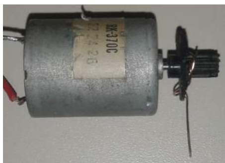
Figura 30 – Dispositivo para simulação do batimento das asas de moscas-das-frutas.
