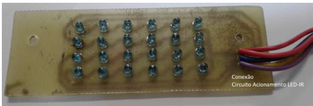
Figura 25 – Circuito implementado do emissor.
