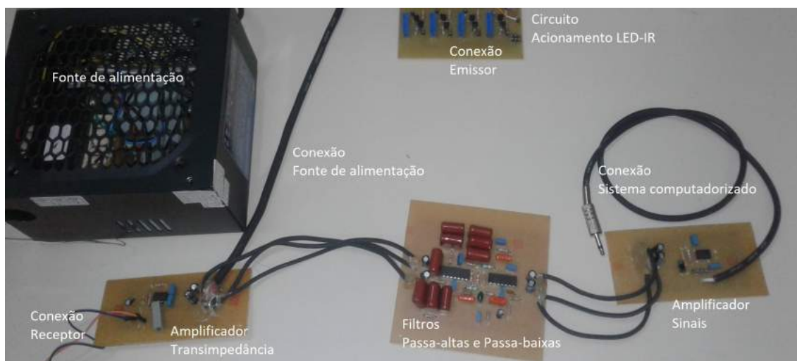
Figura 28 – Circuitos implementados do hardware do sensor optoeletrônico.
