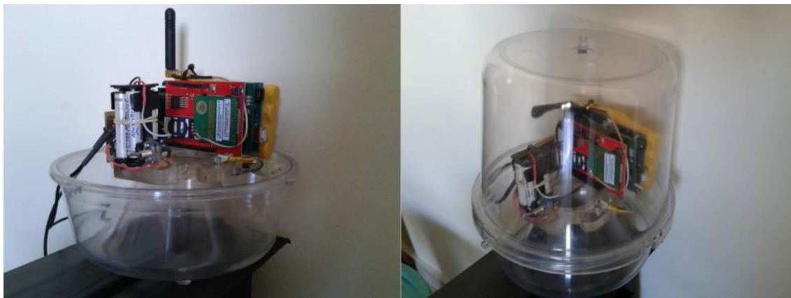
Figura 7 – Armadilha inteligente desenvolvida por Potamitis, Rigakis e Fysarakis (2014).
