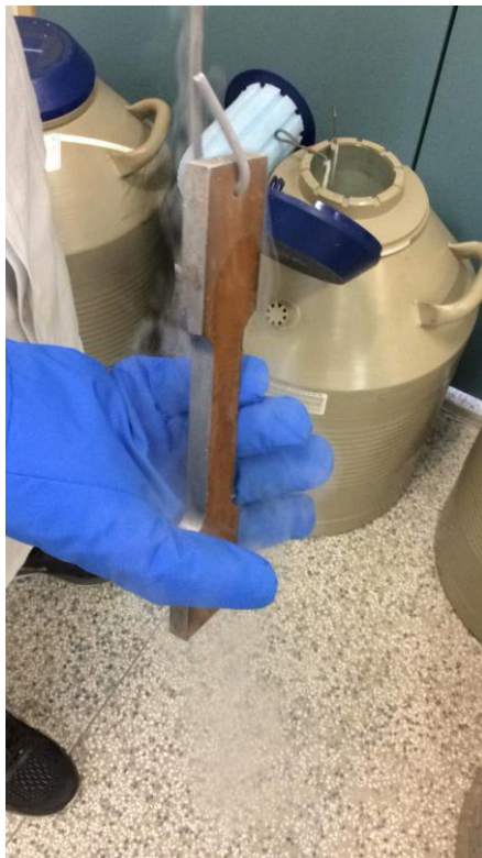
Figura 11 - Corpo de prova adaptado para tratamento de criogenia por imersão em nitrogênio líquido.
