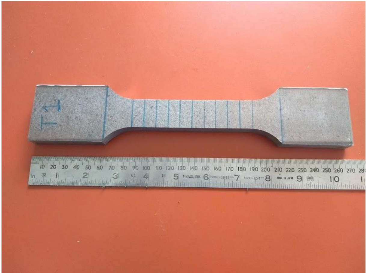
Figura 9 – CP para ensaio de tração.
