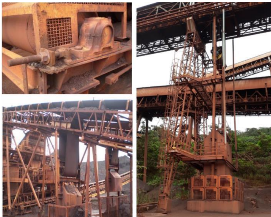
Figura 14 – Esticador de Correia Transportadora fuso e gravidade.
