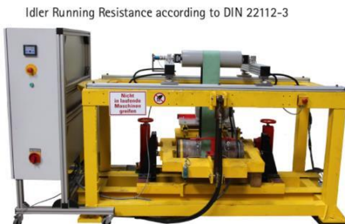
Figura 45 – Bancada de teste de roletes de carga ITA.
