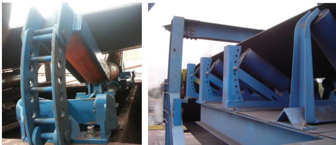
Figura 8 – Roletes de carga com cavaletes de transição
