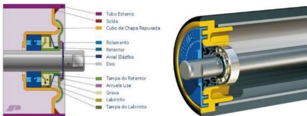
Figura 44 – Componentes rolete de carga.
