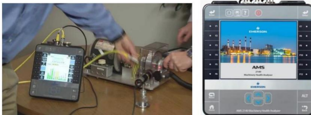
Figura 55 – Coletor de vibração EMERSON CSI 2140.
