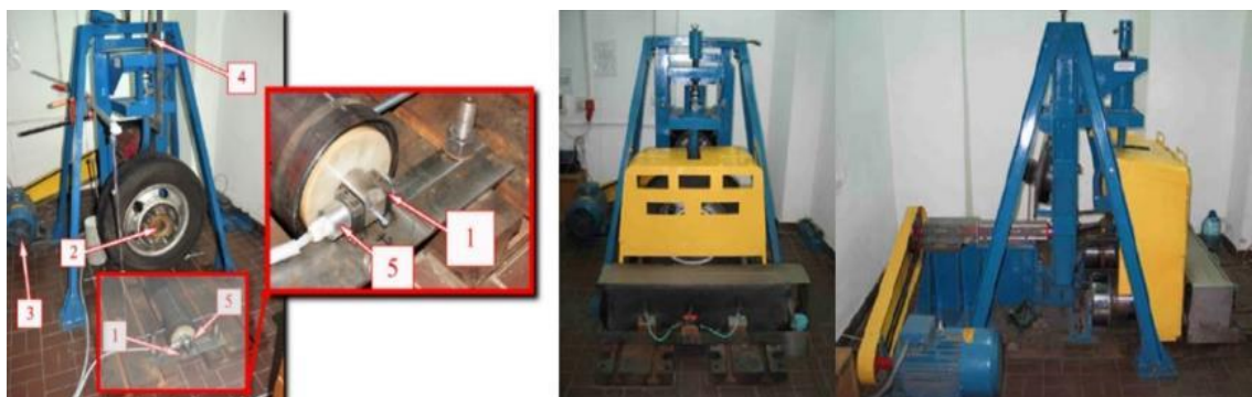
Figura 47– Suporte de medição para testes de durabilidade de roletes.
