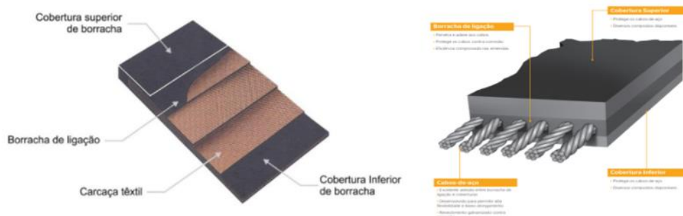
Figura 2 – Carcaça e cobertura de correias transportadoras.
