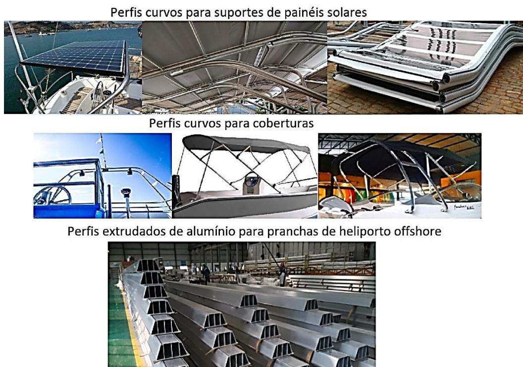
Figura 1-1 Perfis de alumínio curvos na indústria naval
