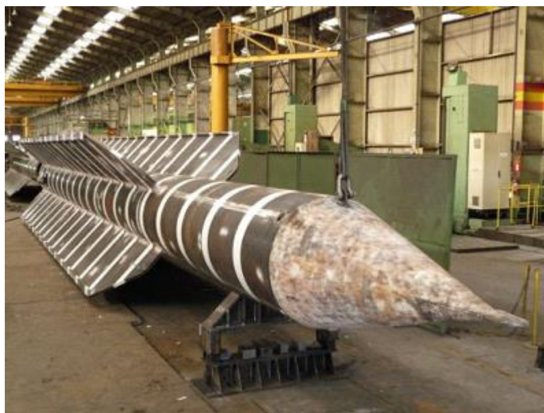
Figura 2.9: Exemplo de estaca (âncora) torpedo (COPPE/UFRJ).
