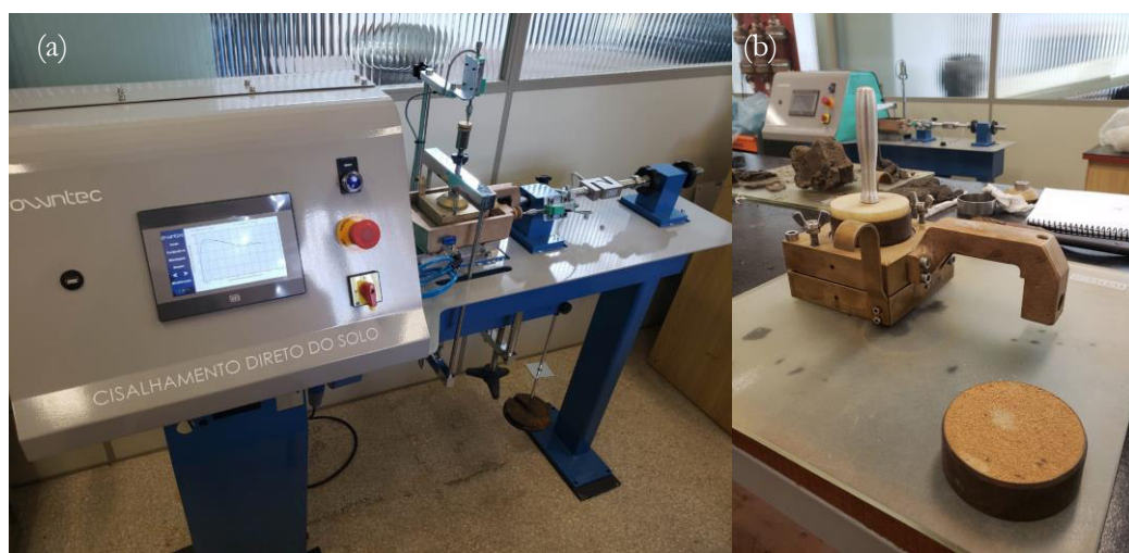
Figura 3.5: Ensaio de cisalhamento direto: (a) execução do ensaio e (b) preparação dos corpos de prova.
