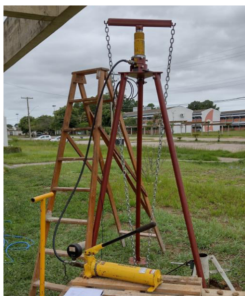
Figura 3.12: Configuração do ensaio de capacidade de ancoragem.
