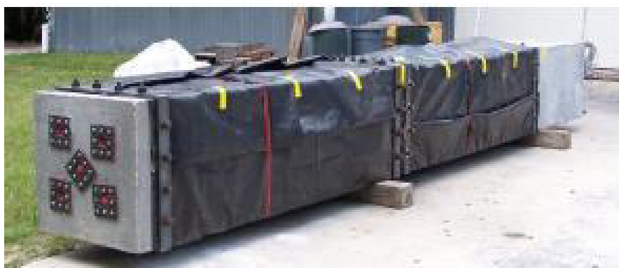
Figura 2.20: Estaca Jetted and Grouted Precast Pile (JGPP) logo após fabricação (Thiyyakkandi et al. , 2017).
