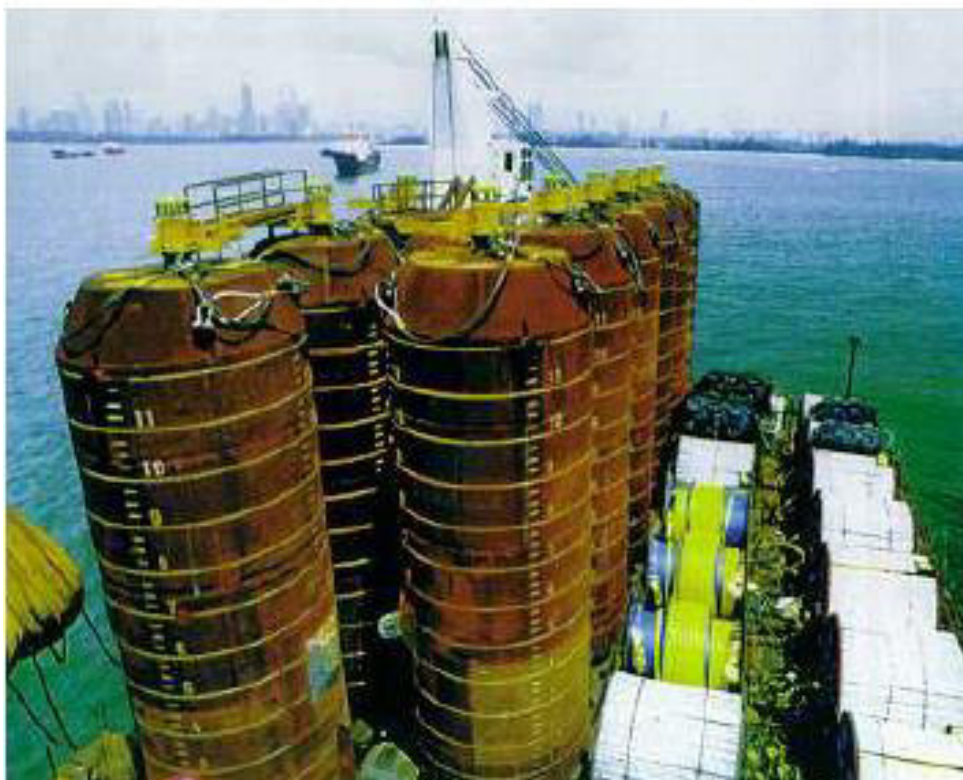
Figura 2.5: Exemplo de estaca de sucção (Randolph et al. , 2005).
