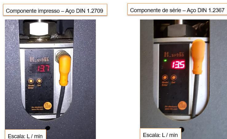
Figura 33 - Medição do fluxo de água que passa pelos canais de refrigeração dos componentes de teste do molde já montados no molde.
