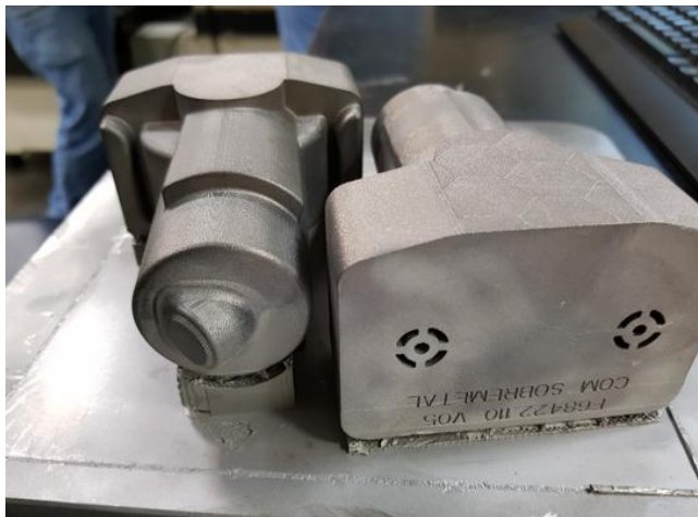
Figura 63 - Componente com falha de estratégia de impressão
