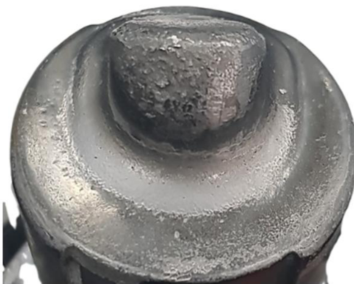
Figura 39 - Componente impresso com teste de vida após 80.000 ciclos de injeção.
