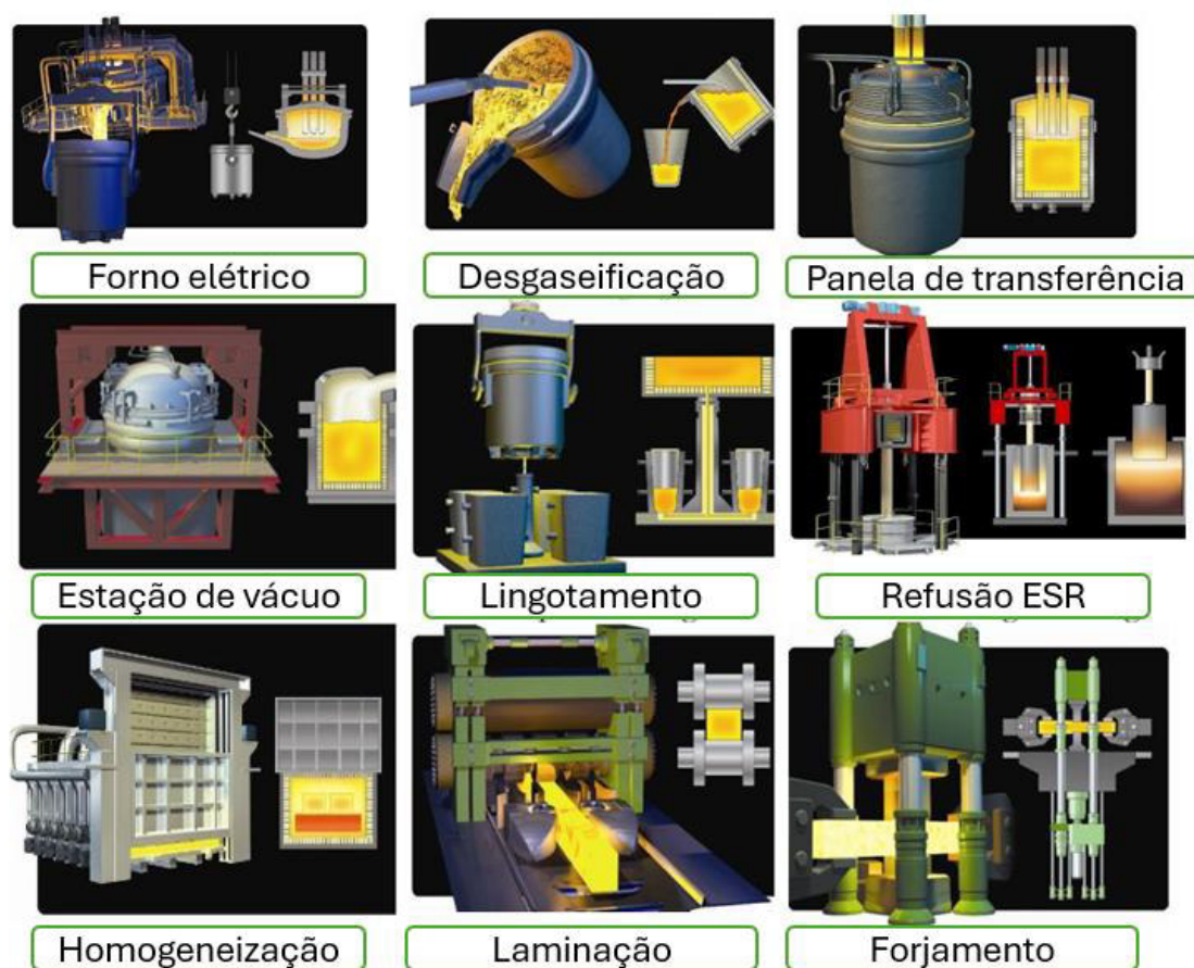
Figura 11 - Processo de obtenção de um aço ferramenta pelo processo de Electro Slag Remelting ou ESR
