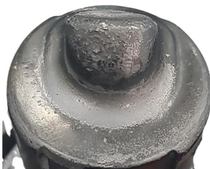
Figura 59 - Componente impresso com teste de vida após 80.000 ciclos de injeção.
