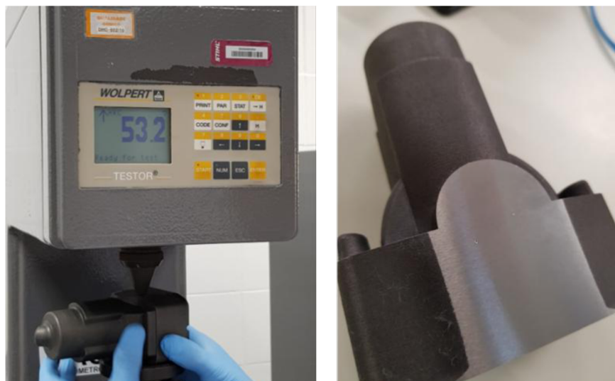
Figura 20 - Medição de dureza do componente impresso como recebido em escala Hockwell C
