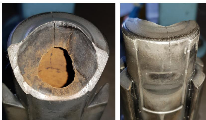
Figura 61 - Componente com uma quebra catastrófica proveniente de um ponto de oxidação
