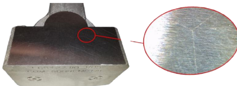
Figura 43 - Componente impresso não conforme
