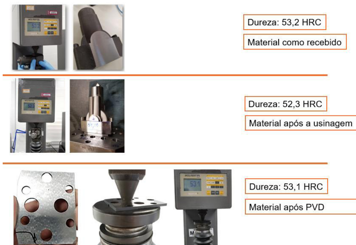
Figura 52 - Comparativo de dureza do substrato durante as fases de fabricação.
