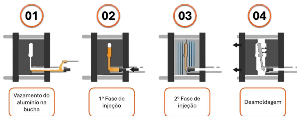
Figura 2 - fluxo de processos de injeção de alumínio
