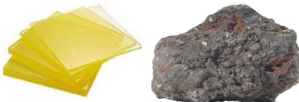
Figura 3 – Materiais utilizados: Poliuretano puro e rejeito magnético
