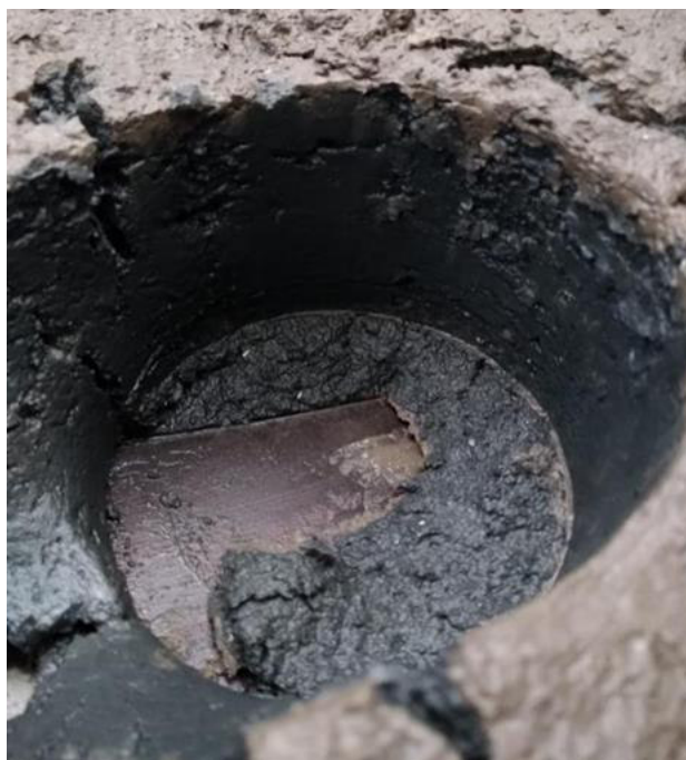
Figura 5.26 – Textura do sedimento retido após os três ciclos de enchimento com polímero
