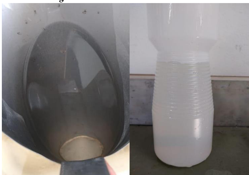
Figura 5.25 – Efluente desaguado após o último ciclo de enchimento.
