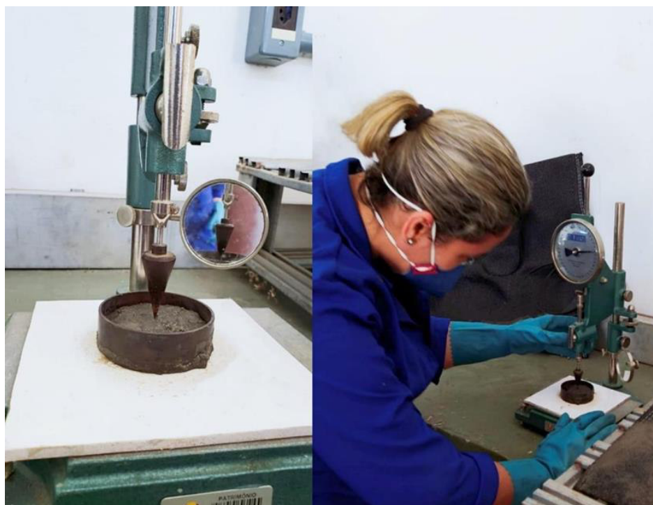
Figura 4.16- Ensaio cone de queda. a) posicionamento do cone na amostra; b) realização do ensaio.
