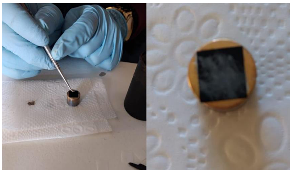
Figura 4.19- Preparo da amostra para o procedimento do MEV.
