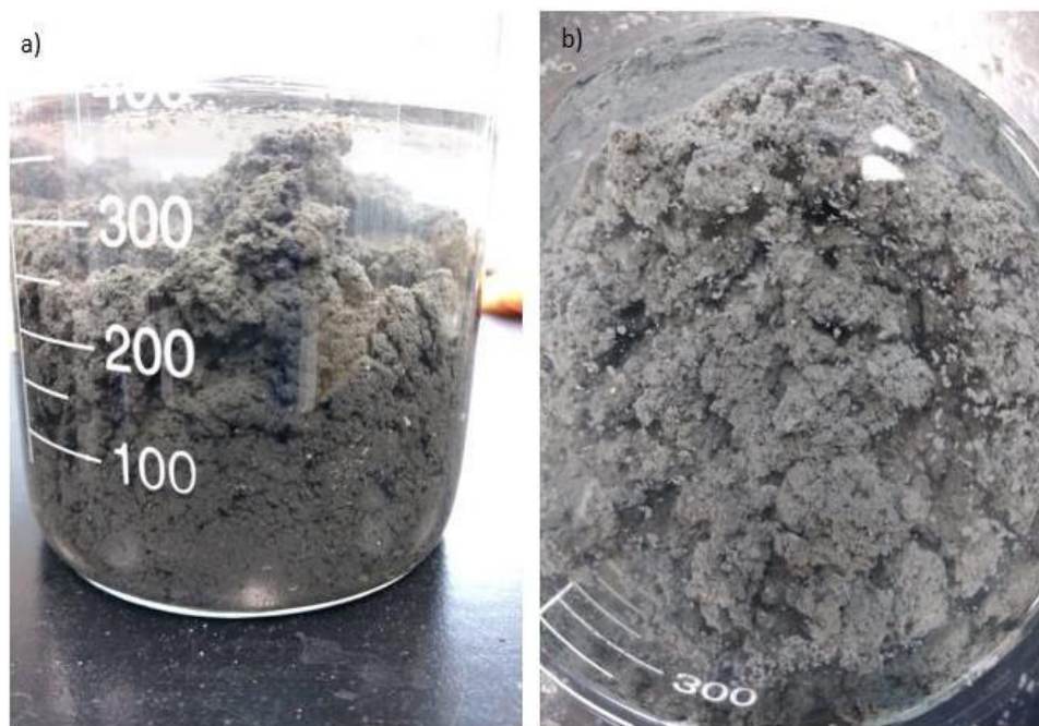
Figura 5.12- Mistura entre solo e polímero; a) vista lateral; b) vista da superfície de cima do becker.
