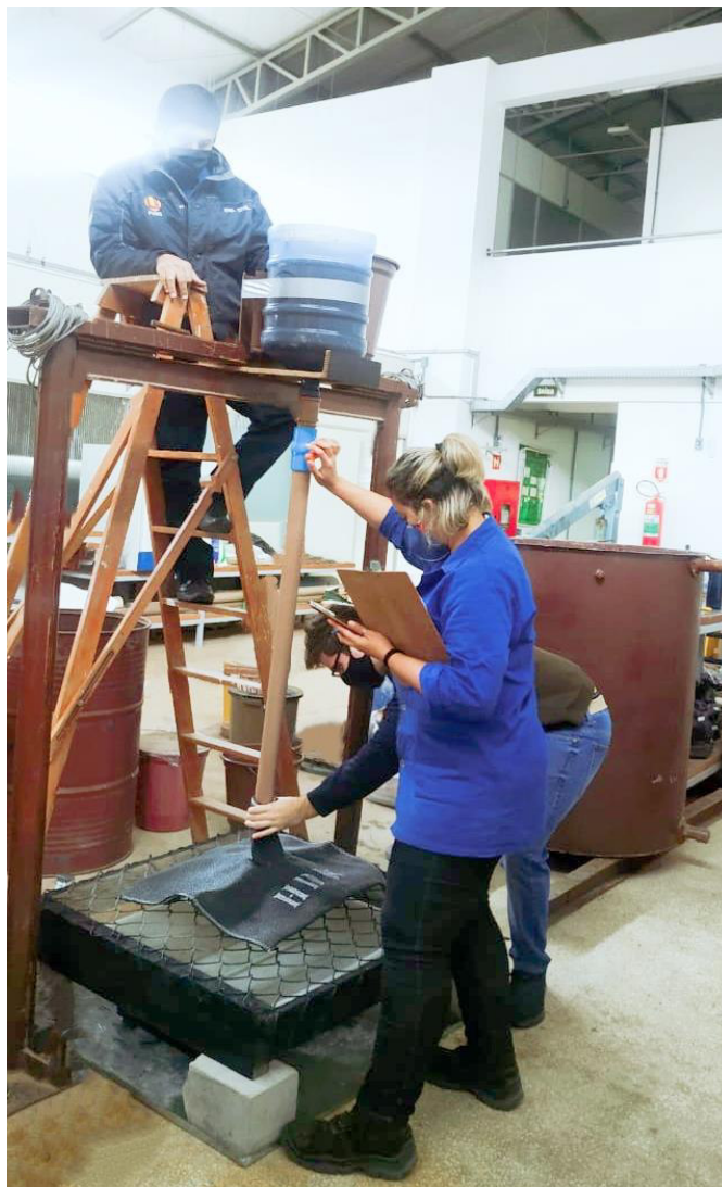
Figura 5.18 - Teste de desaguamento em bolsa de pequena dimensão
