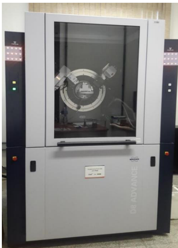
Figura 4.18 - Difratômetro de Raios X com câmara para temperaturas criogênicas, Bruker, D8 Advance. (Fonte: CEME SUL - FURG)
