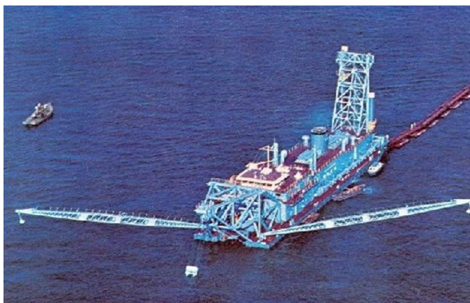
Figura 2.5 - Dragas de Sucção e Recalque com Desagregador (SR).
