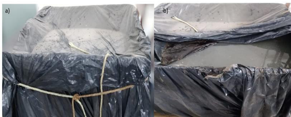
Figura 4.4. Preservação da amostra: a) armazenamento do material; b) preservação do material com água salgada.
