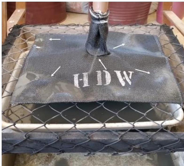
Figura 5.20- Procedimento de enchimento do ensaio BAG1 sem adição de polímero.
