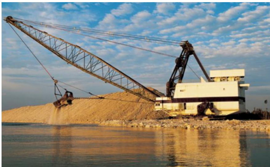
Figura 2.3 - Draga pá de arrasto ( Dragline )
