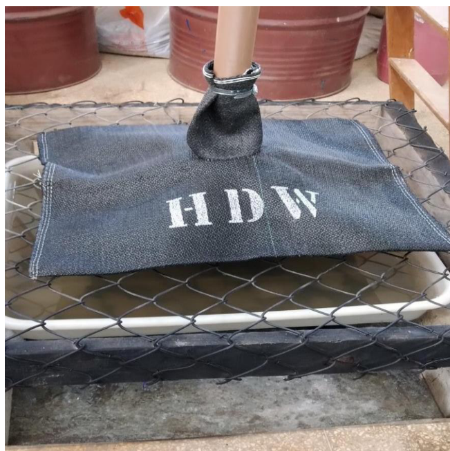
Figura 5.22 - Ensaio BAG2 com um único ciclo de enchimento
