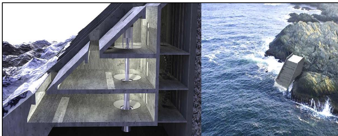
Figura 2.9 – Ilustração de um dispositivo do tipo SSG: a) vista lateral e b) ilustração da instalação do dispositivo (Margheritini et al. , 2009).
