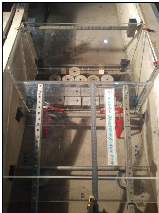
Figura 4.7 – Detalhes da primeira montagem do dispositivo de galgamento no canal de ondas do IPH.
