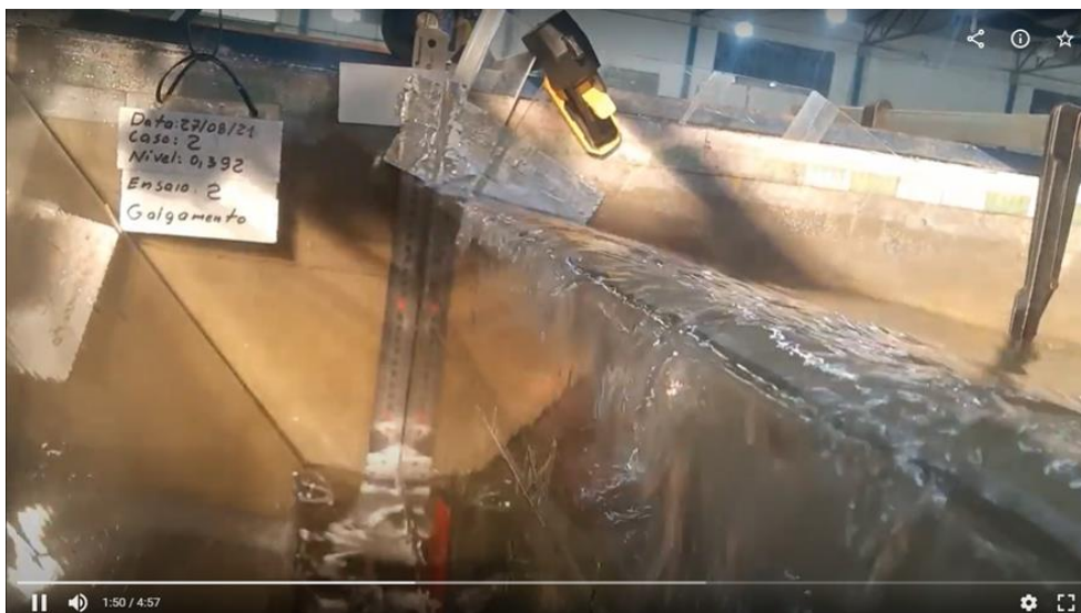
Figura 5.22 - Comportamento instantâneo experimental do dispositivo de galgamento para o caso 2.0 ( H_1/L_1 = 0,50 ) no instante de tempo t = 50 s (ensaio iniciado após 60 s de filmagem).
