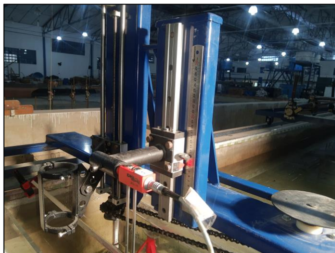
Figura 4.11 – Processo de nivelamento das sondas.
