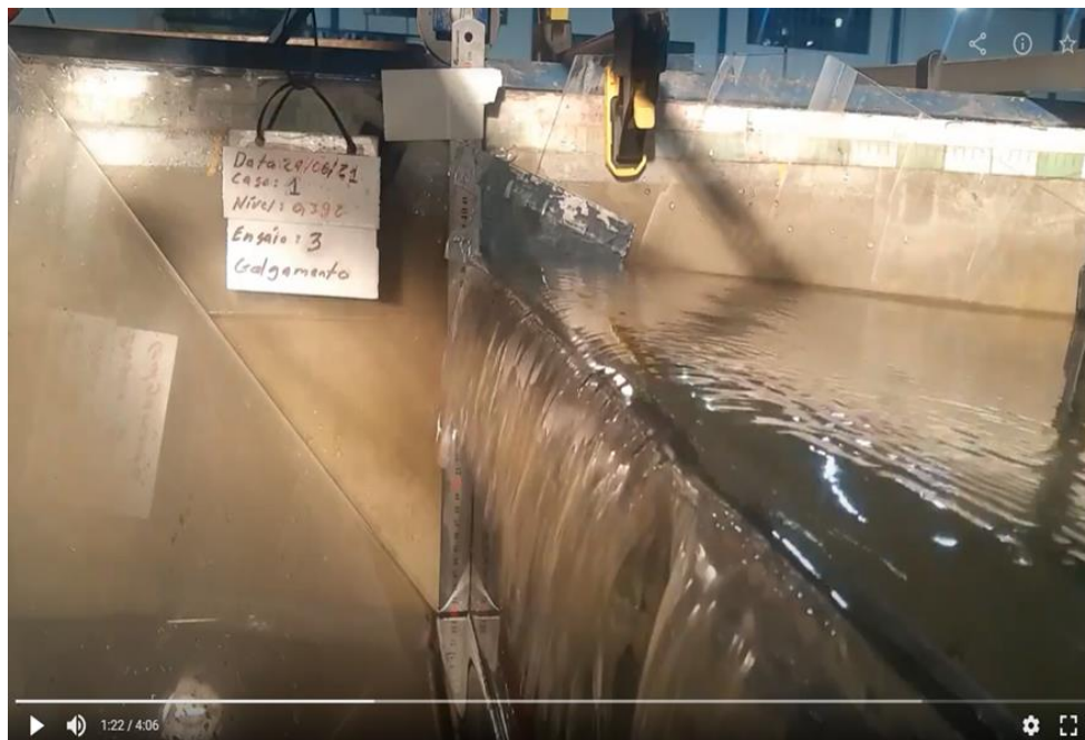
Figura 5.10 – Ilustração da ocorrência do primeiro galgamento no estudo experimental para o caso 1.0 ( H_1/L_1 = 0,39 ) no instante de tempo t = 22 s (ensaio iniciado após 60 s de filmagem).
