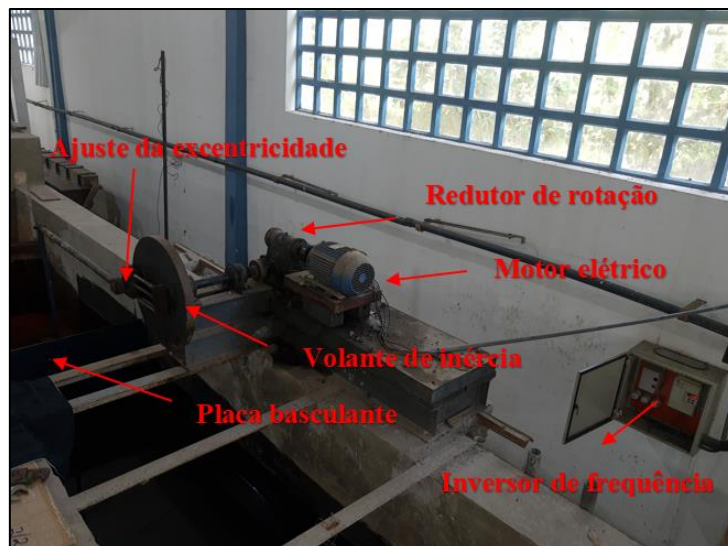
Figura 2.16 – Partes do gerador de ondas do IPH
