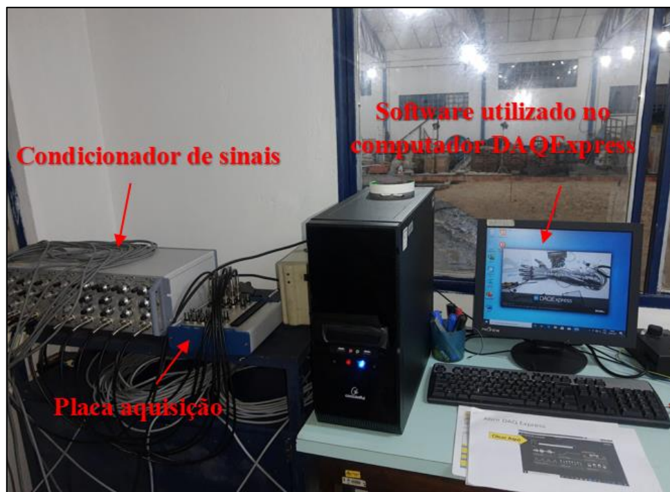
Figura 4.2 – Esquema de aquisição de dados utilizado.
