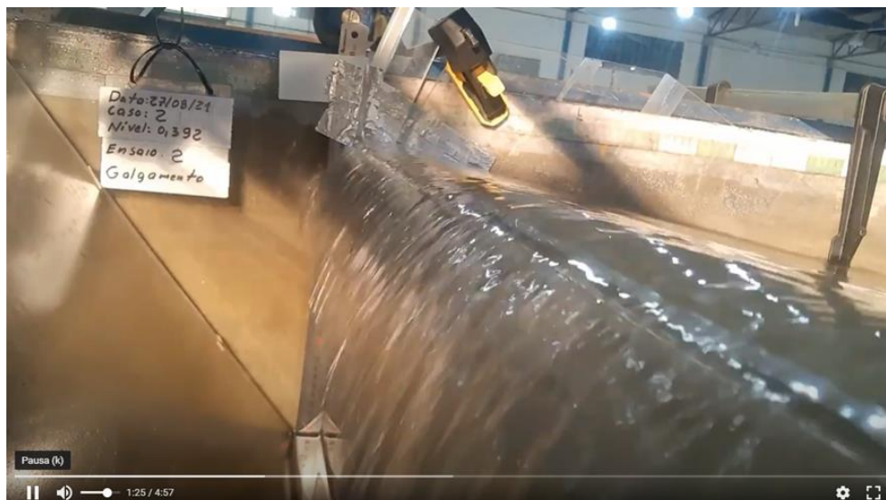
Figura 5.20 - Ilustração da ocorrência do primeiro galgamento no estudo experimental para o caso 2.0 ( H_1/L_1 = 0,50 ) no instante de tempo t = 25 s (ensaio iniciado após 60 s de filmagem).
