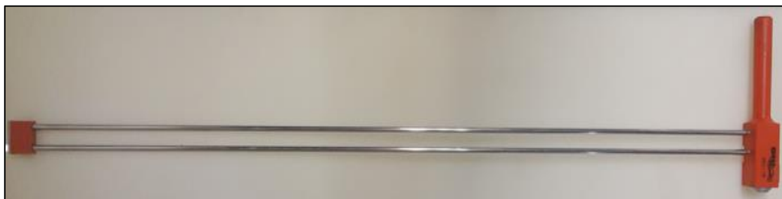
Figura 4.1 – Sensor condutivo para medição da altura de onda.
