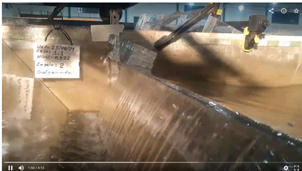
Figura 5.17 - Comportamento instantâneo experimental do dispositivo de galgamento para o caso 1.1 ( H_1/L_1 = 0,44 ) no instante de tempo t = 50 s (ensaio iniciado após 60 s de filmagem).
