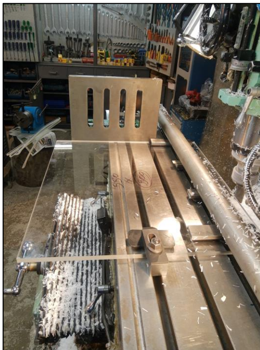
Figura 4.5 - Usinagem das placas do dispositivo de galgamento.
