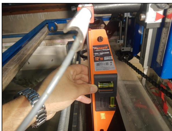
Figura 4.9 – Processo de nivelamento das sondas.
