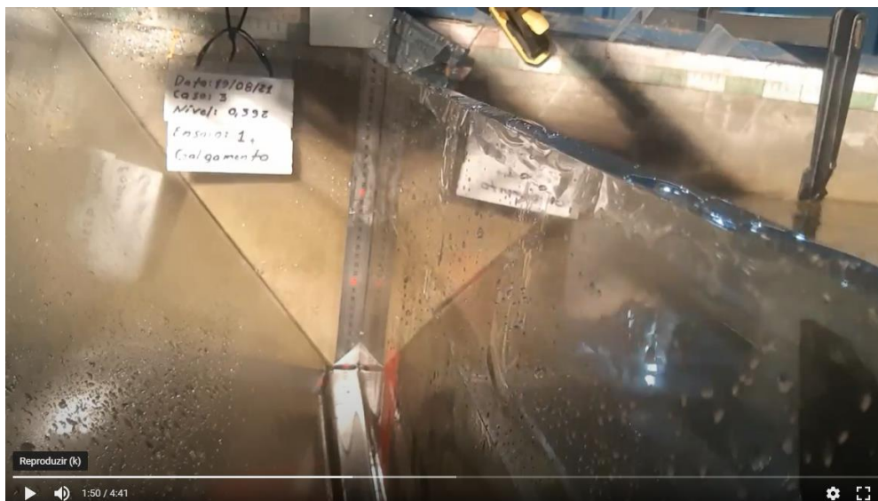
Figura 5.27 - Comportamento instantâneo experimental do dispositivo de galgamento para o caso 3.0 ( H_1/L_1 = 0,59 ) no instante de tempo t = 50 s (ensaio iniciado após 60 s de filmagem).
