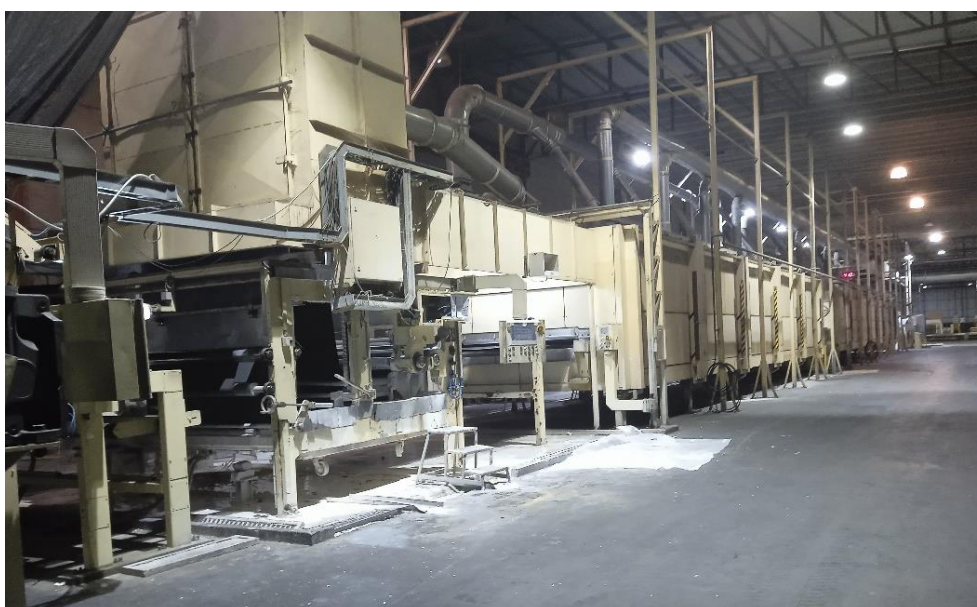
Figura 7 - Processo de impregnação de papel melamínico
