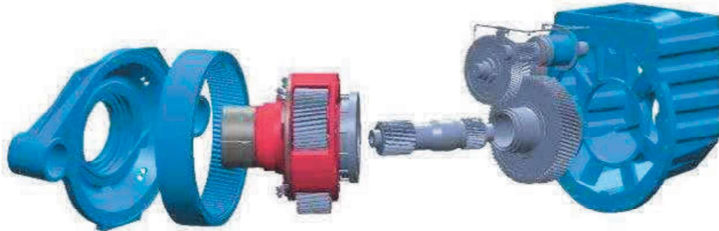
Figura 6 - Componentes de uma caixa de velocidades comum
