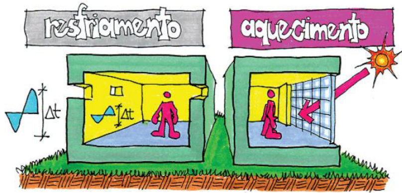
Figura 4 - Inércia térmica para aquecimento ou para resfriamento.
