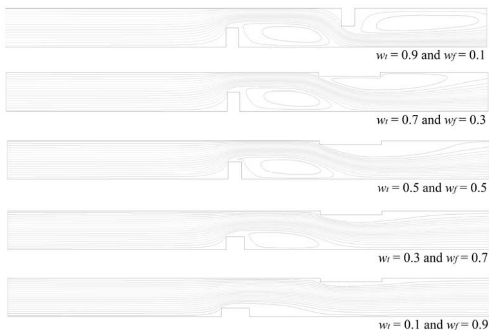
Figura 5.31 – Campos de linhas de fluxo para as geometrias ótimas multi-objetivo com ebulição para diferentes combinações de pesos dos objetivos.
