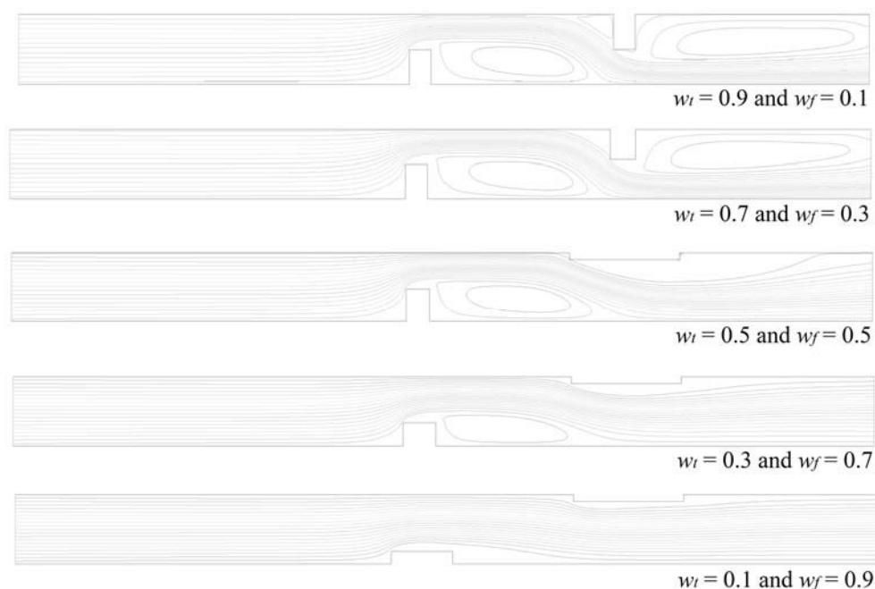
Figura 5.35 – Campos de linhas de fluxo para as geometrias ótimas multi-objetivo sem ebulição para diferentes combinações de pesos dos objetivos.
