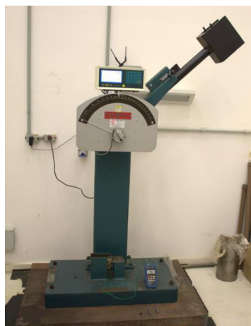
Figura 8 - Pêndulo de impacto utilizado no ensaio Charpy.
