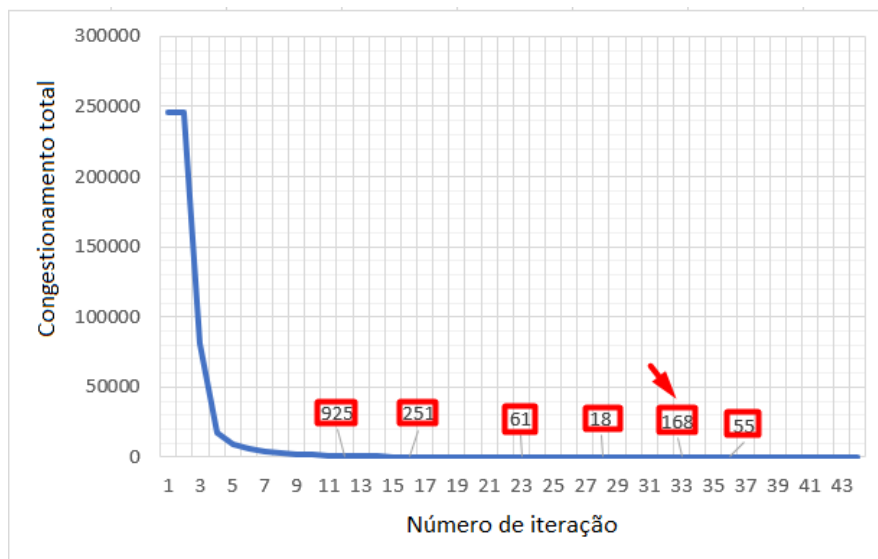
Figura 28: Congestionamento total x número da iteração durante a execução do benchmark adaptec1 ,
